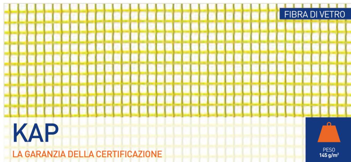
Rete in fibra di vetro dal peso nominale di 145 g/m<sup>2</sup> con elevate resistenze meccaniche longitudinali e trasversali. La maglia molto fitta (3,5 x 4 mm) la rende particolarmente adatta per rivestimenti a cappotto e rasature.
