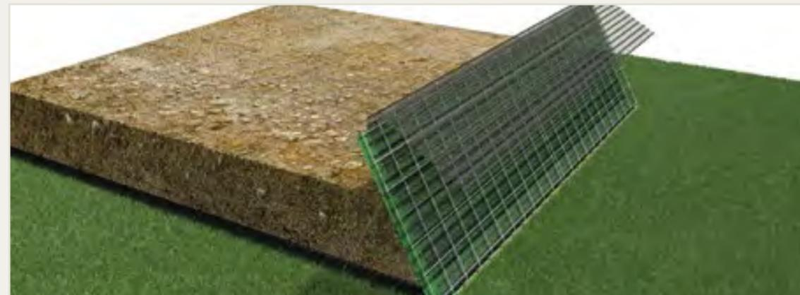
**5** - Posizionare e compattare il materiale di riempimento fino al livello successivo delle geogriglie, utilizzando idonei rulli compattatori e mantenendo una distanza minima di 1.5 m del fronte del pendio. In prossimità della facciata, procedere con la compattazione utilizzando un compattatore più leggero (tipo piastra vibrante con massa complessiva inferiore a 1000 kg).
