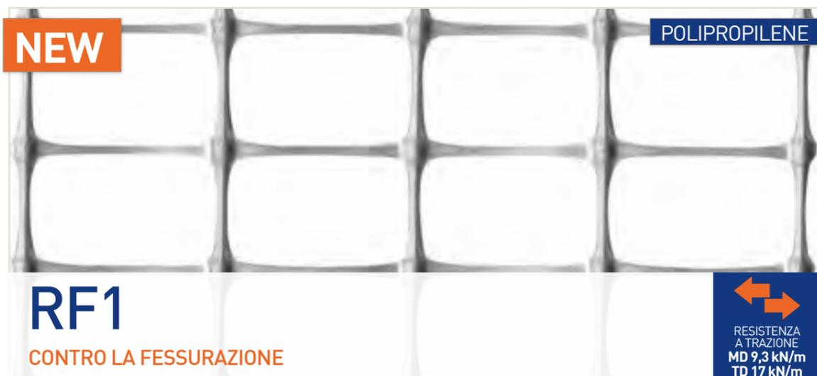
Rete bi-orientata in polipropilene sottoposta a doppio trattamento di orientamento molecolare per conferire elevati valori di resistenza alla trazione e ottimale modulo elastico. Utilizzabile per massetti di spessore 5-6 cm o intonaci fino a 3-4 cm, per limitare la fessurazione da ritiro plastico e il fenomeno dello "slump" in casi di miscele poco consistenti o supporti poco aderenti. Perfetta per sostituire le classiche reti elettrosaldate.
