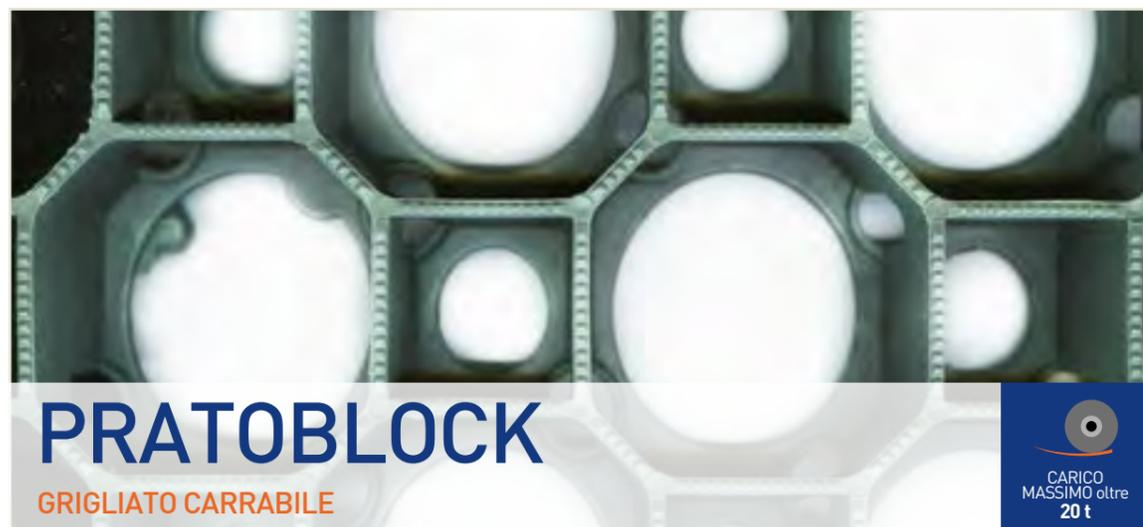
Grigliato carrabile in HDPE in moduli (50x50 cm) agganciabili utilizzato per la realizzazione di pavimentazioni erbose. Offre un'elevata resistenza a compressione e una bassa capacità termica limitando così l'aumento di temperatura e le conseguenti dilatazioni.
