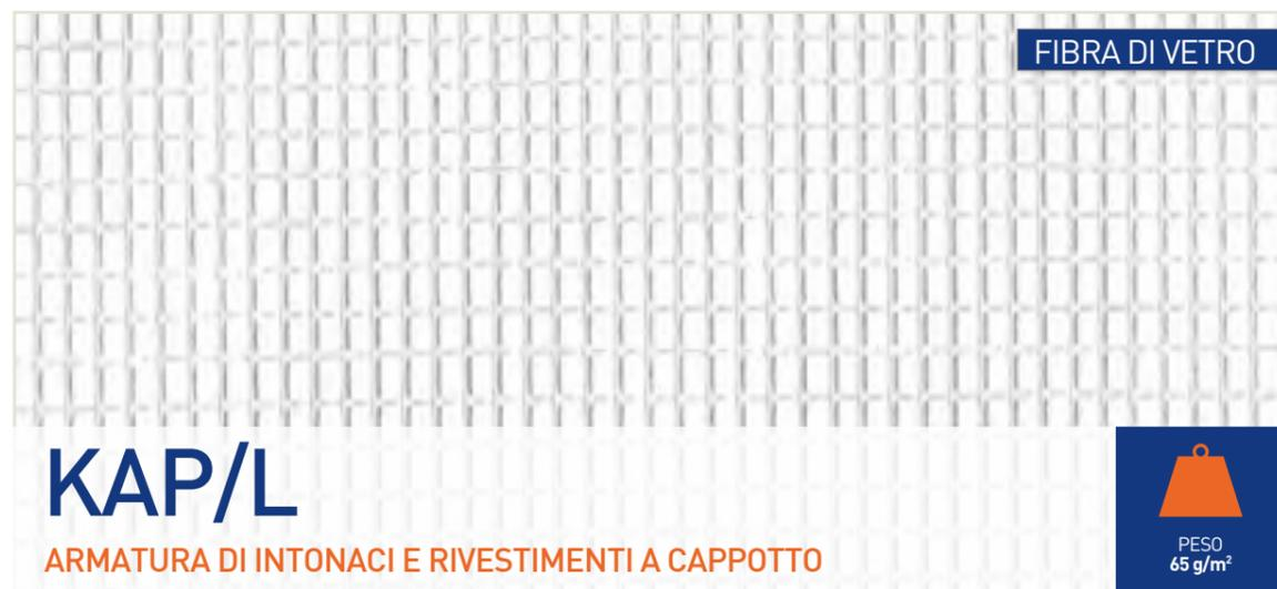
La rete TENAX KAP/L da 65 g/m<sup>2</sup> è costituita da filati in fibra di vetro pura al 100%. Caratterizzata da un apposito equilibrio di spessore e grammatura, si rivela particolarmente leggera e flessibile, mantenendo buone doti di resistenza alla trazione.
