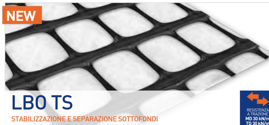
Geocomposito per la separazione e la stabilizzazione dei terreni costituito dall'accoppiamento industriale di geogriglie in PP biorientate con un geotessile nontessuto in PP da 140 g/m².
